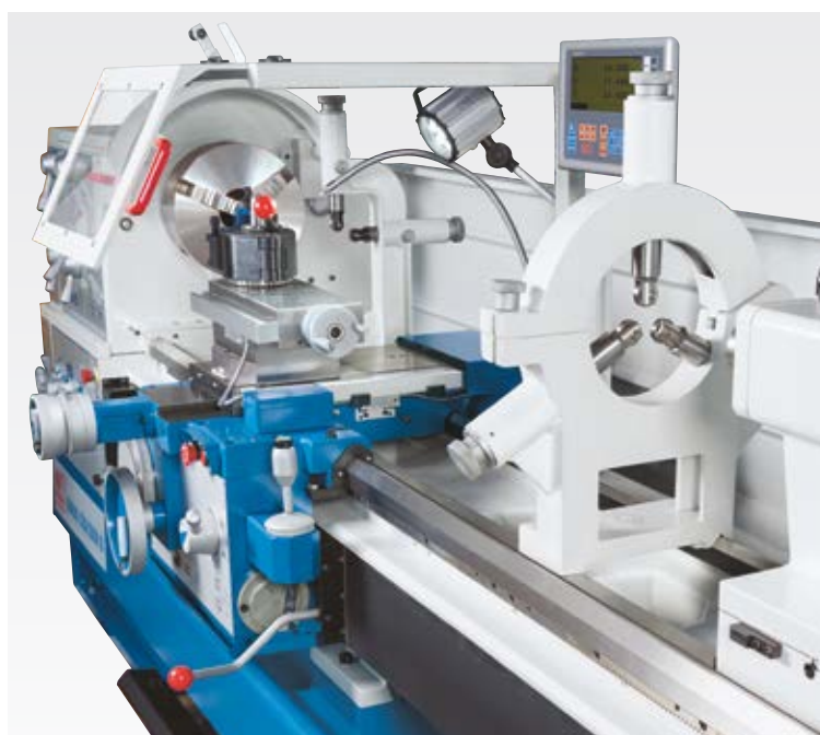
Люнеты для точной обработки длинных заготовок
