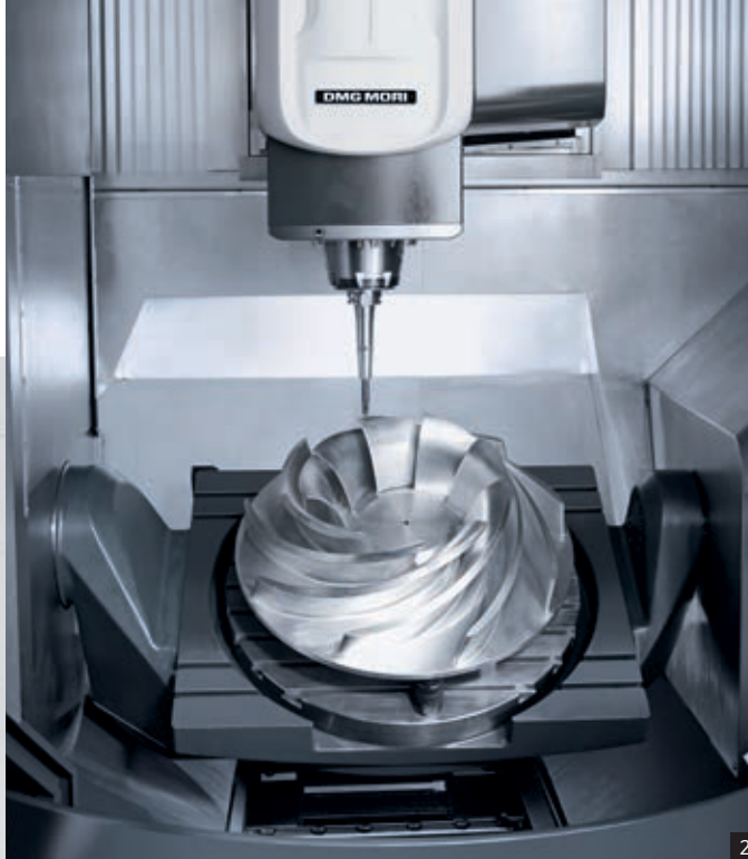
2: Одновременная 5-осевая обработка с поворотным столом с ЧПУ и мотор-шпинделем на 20 000 оборотов
