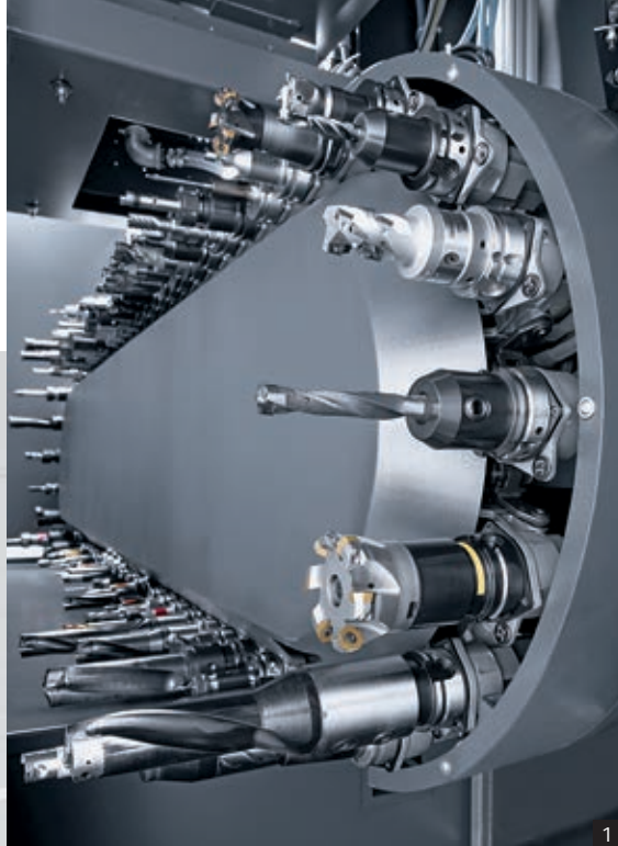
1: Магазин цепного типа на 60 инструментов
