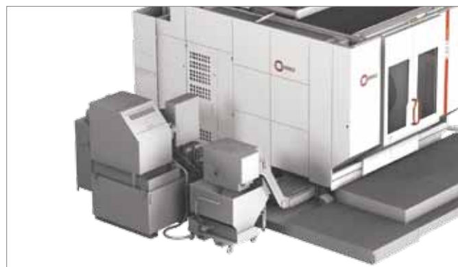
Транспортер для стружки с обратным охлаждением СОЖ IKZ 80 и внутренней подачей СОЖ
