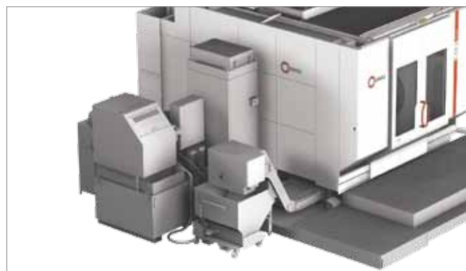
Транспортер для стружки с внутренней подачей СОЖ IKZ 80, обратным охлаждением СОЖ и вытяжкой масляного тумана
