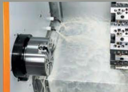
Охлаждающая жидкость сливается на кожух (Фото с опцией насоса Grundos MTH4-40/4)
