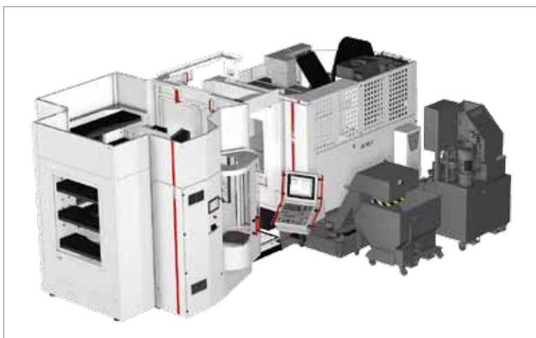
HS flex с двумя накопительными модулями и местом комплектации, адаптирована к обрабатывающему центру С 12 U
