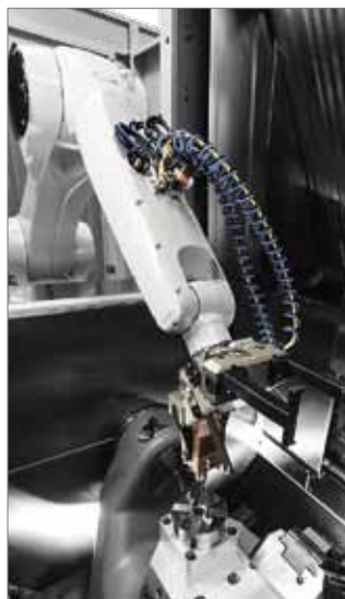
Установка заготовки с помощью робототехнической системы
