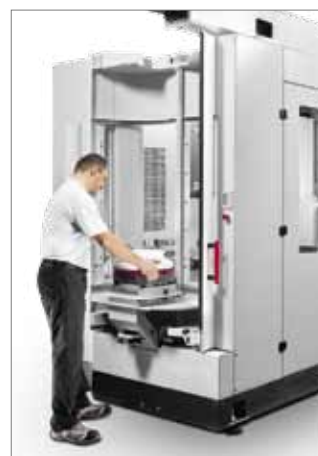
Место комплектации устройства смены паллет
