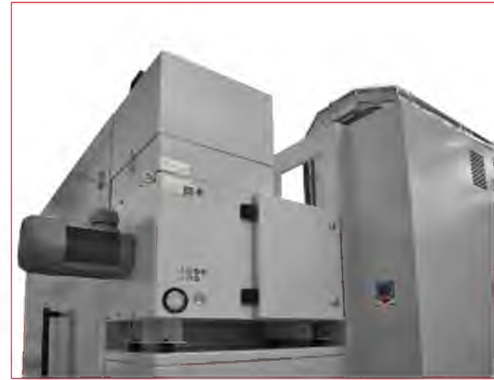
Impianto di aspirazione fumi lavorazione. Machining's fumes suction system. Bestrebung Anlage von Rauch Bearbeitung. Système d'aspiration fumées d'usinage.
