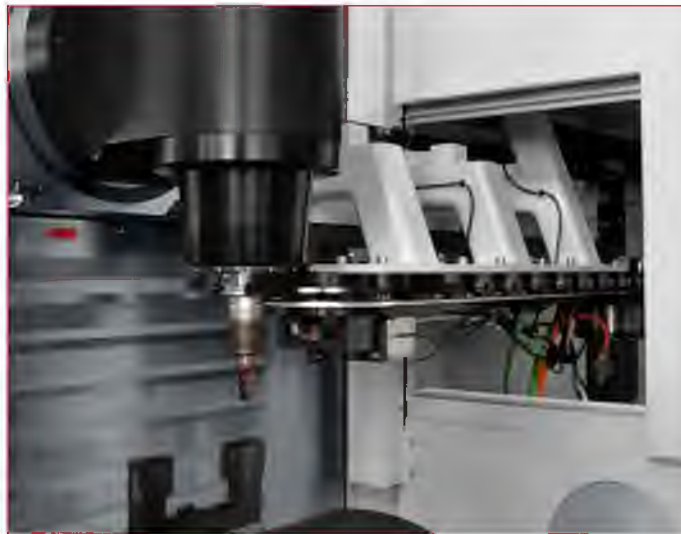
Magazzino a catena con traslazione fissato lateralmente al basamento della macchina. Chain type magazine with traverse fixed on the side of the machine base. Kettenwechsel mit Überführung, seitlich an der Maschine angeordnet. Magasin à chaîne avec traslation fixé latéralement à la fondation de la machine.
