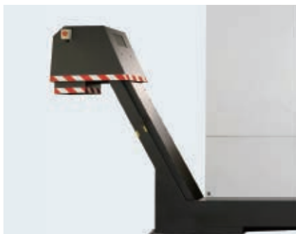
Стандартное устройство смены инструмента рычажного типа на 24 насадки
