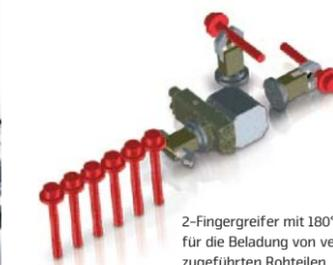
2-Fingergreifer mit 180°-Drehmodul für die Beladung von vertikal zugeführten Rohteilen
