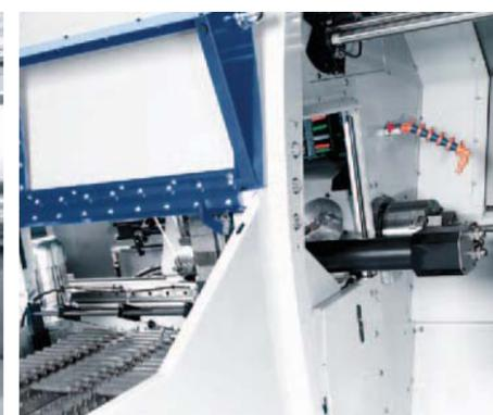
Vollautomatische Beladung von Wellen. Zuführung über Taktband, Abführung über die Fertigteilauflangvorrichtung.
