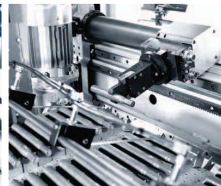
Taktförderband mit Prismenauflagen für unterschiedlich vorgeformte Wellenteile.
