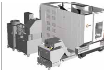
Транспортер для стружки с агрегатом обратного охлаждения и внутренней подачей СОЖ слева
