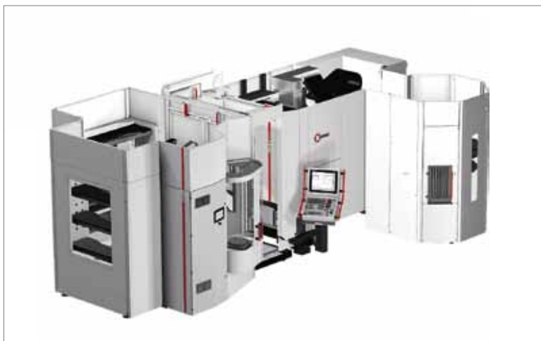
HS flex с двумя накопительными модулями и местом комплектации, адаптирована к обрабатывающему центру C 22 U
