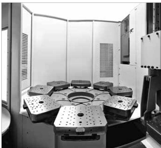
Устройство смены паллет PW 150 с местом для комплектации и 8-местным накопителем
