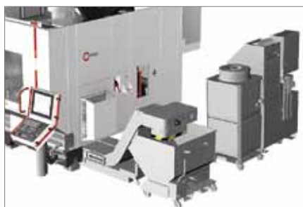
Транспортер для стружки с агрегатом обратного охлаждения и внутренней подачей СОЖ справа
