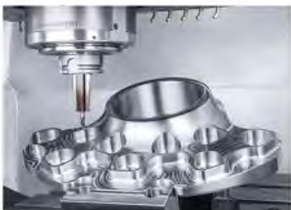
2: Шпиндель-двигатель SK40, 20 000 об/мин, 130 Нм, 35 кВт (40% ED)
