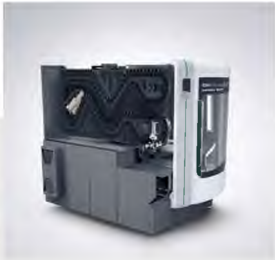
1: Двойной рейфер 2: Интегрированный цепной магазин на 120 позиций, не занимает дополнительную площадь
