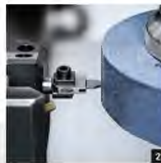
1: Устройство для определения наличия заготовки с помощью нагрузки на шпиндель 2: Акустический датчик для устройства правки
