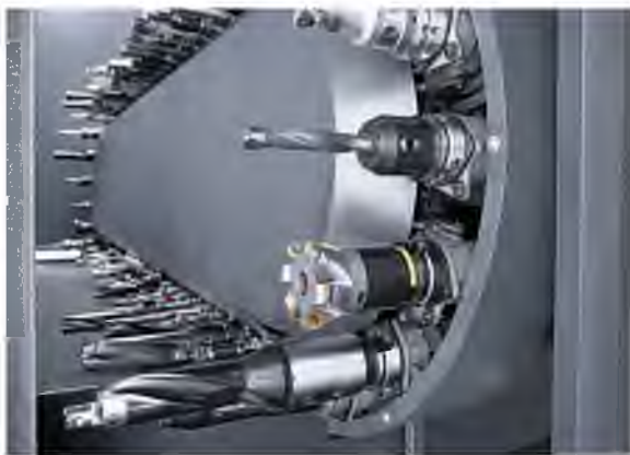
3: Цепной магазин на 60 инструментов, SK40
