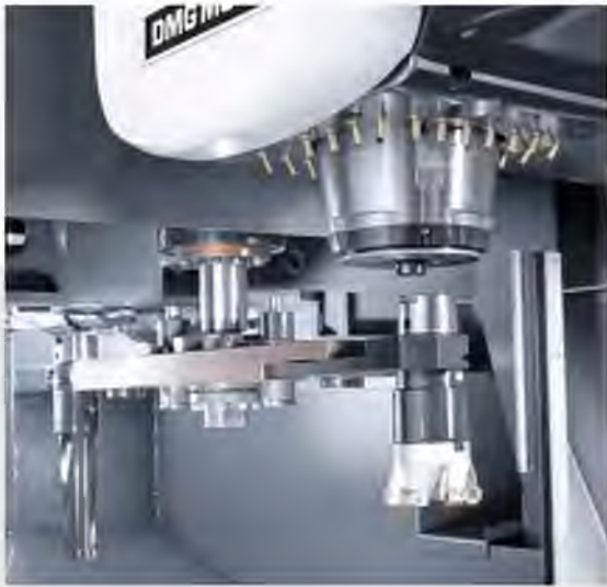
1: Двойной рейфер 2: Интегрированный цепной магазин на 120 позиций, не занимает дополнительную площадь
