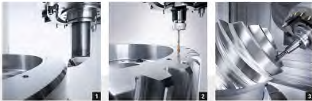
1: Токарная обработка 2: Нарезание резьбы 3: Нарезание зубчатых колес стандартным инструментом
