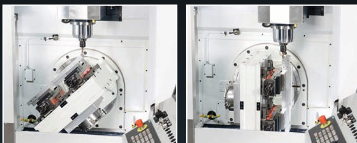
Зажимной стол для U4-1530 Зажим детали возможен с двух сторон стола
