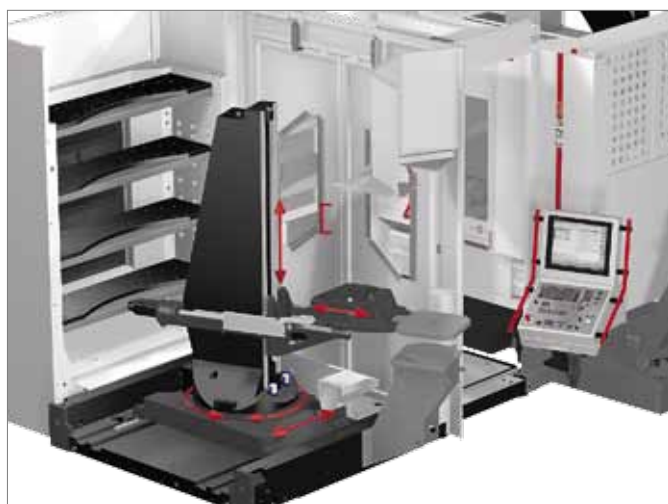
Функциональная концепция и концепция перемещений транспортно-загрузочной системы. Компактное исполнение и размещение, не требующее больших производственных площадей, с оптимальным доступом для оператора станка
