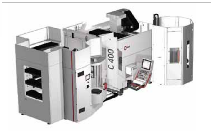
HS flex с двумя накопительными модулями и местом комплектации, адаптирована к обрабатывающему центру C 400
