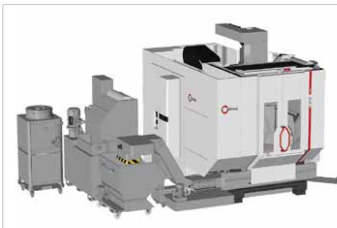
Транспортер для стружки с внутренней подачей СОЖ IKZ 80 и агрегатом обратного охлаждения
