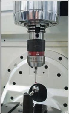
Система измерения инструмента устанавливаемая на столе
