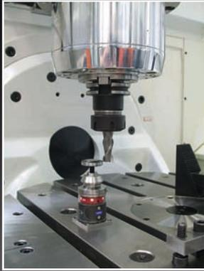
Тактильная или лазерная система измерения инструмента
