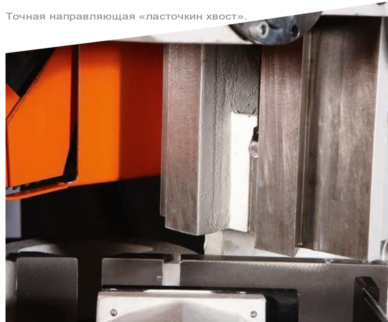
Полуавтомат, пневматическое зажимное устройство.
