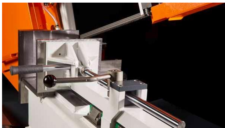
Зажим заготовки быстрым подводом с гидравлическим поджимом
