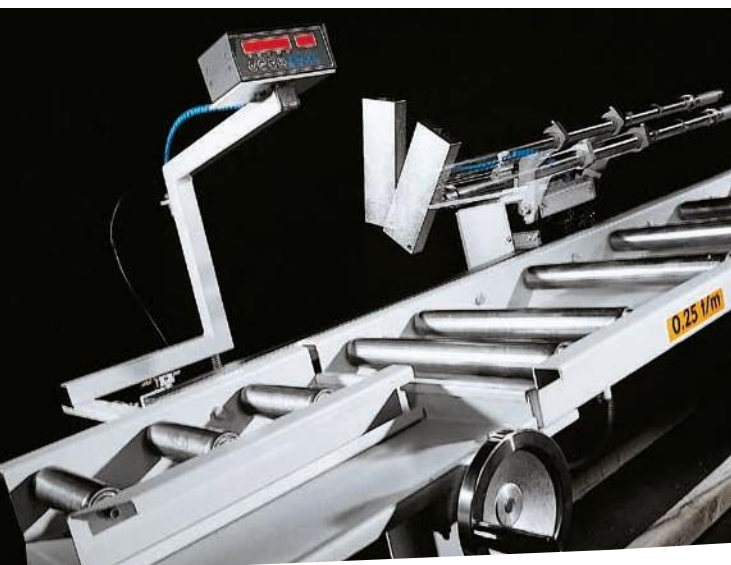
Цифровой измерительный стопор KASTOstop U 2.
