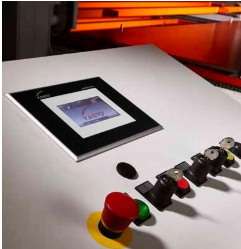
Управление хранением с предварительным выбором отсека и ключом согласования.
