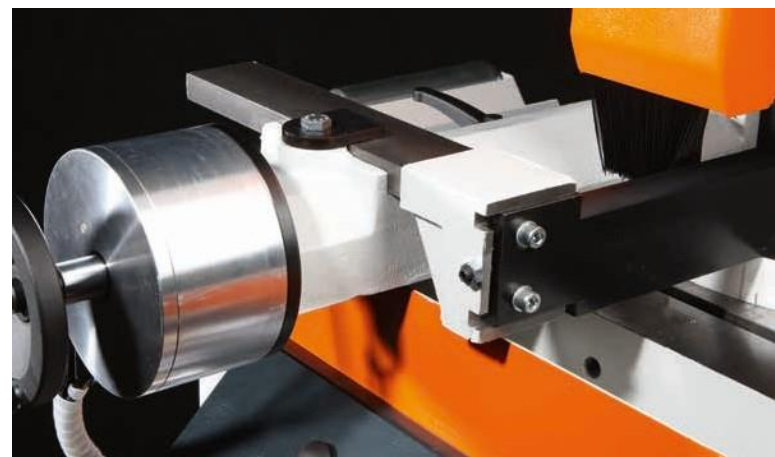
Полуавтомат, пневматическое зажимное устройство.
